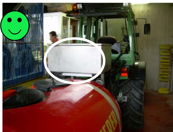
Fig. 7 – Trasporto in sicurezza degli agrofarmaci in campo impiegando appositi alloggiamenti presenti sulla macchina irroratrice.
