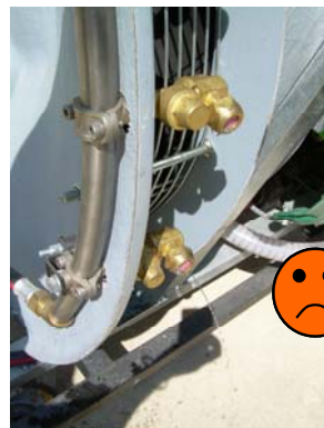
Fig. 37 - Esempio di ugello NON dotato di dispositivi antigoccia (sinistra) e di antigoccia non funzionante (destra).
