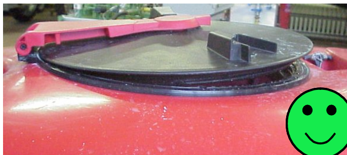
Fig. 44 – Esempio di coperchio del serbatoio principale della macchina irroratrice con adeguato sistema di chiusura.
