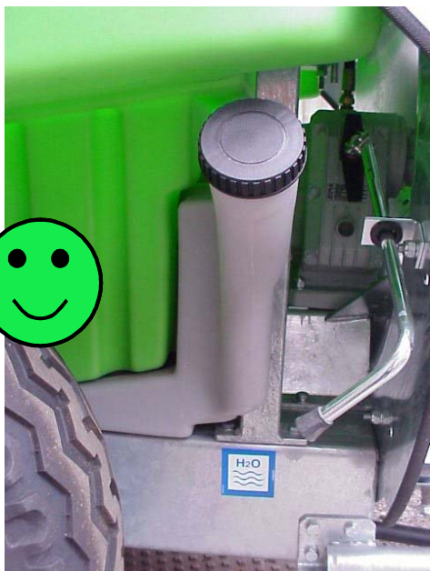
Fig. 42 - Il serbatoio lavaimpianto deve avere almeno il 10% della capacità nominale del serbatoio principale o almeno 10 volte il volume diluibile (EN 12761). La sua presenza consente di effettuare in campo il lavaggio dell'irroratrice e lo smaltimento della miscela residua nel serbatoio principale. Deve essere progettato in modo da consentire il risciacquo delle tubazioni anche con il serbatoio principale pieno e la diluizione del residuo all'interno dello stesso.
