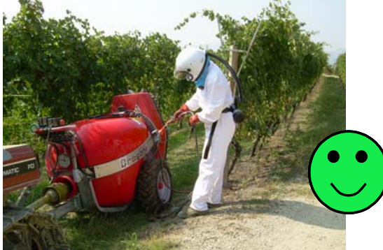
Fig. 85 – Lavaggio esterno della macchina irroratrice in campo al termine del trattamento utilizzando una lancia e l'acqua del serbatoio lavaimpianto.
