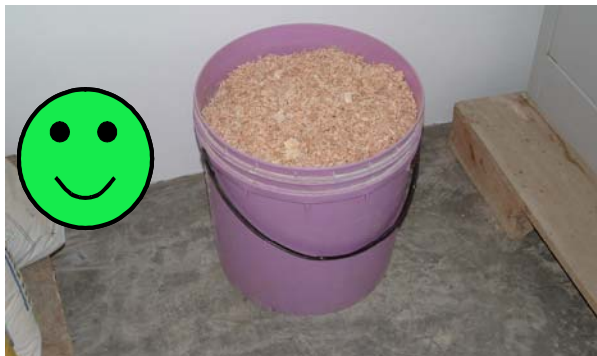
Fig. 30 – Esempio di materiale assorbente (in questo caso segatura) per tamponare eventuali perdite accidentali di prodotto nel magazzino di stoccaggio.
