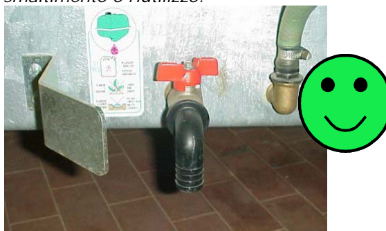
Fig. 45 – Esempio di rubinetto per la raccolta in sicurezza della miscela residua nel serbatoio
