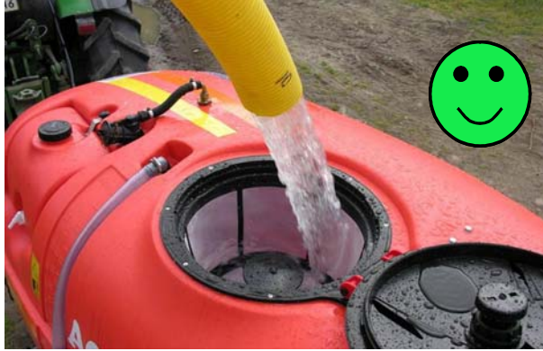
Fig. 61 – Corretto riempimento del serbatoio dell'irroratrice (foto ISK) .
